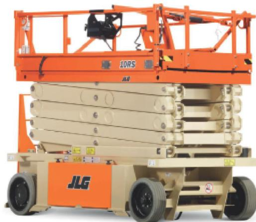
10RS in Transport Konfiguration mit abgeklappten Geländer
