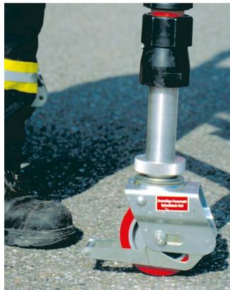
7. Lenkrollen blockieren bzw. Bodenplatten auf sicheren Stand kontrollieren
