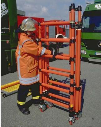
1. Bremsen der Lenkrollen lösen
