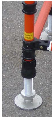
8. Rettungsplattform durch Höhenverstellung mit Schnellverschluss ausrichten, Verriegelung richtig schließen
